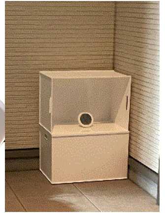
図3 温湿度計の設置
