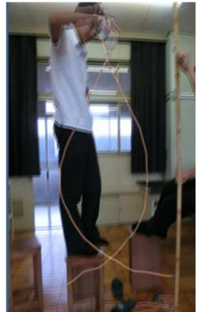
図2 紐を鉛直に垂らし下端を自由端にして回転させたときの様子(2枚の画像の重ね合せ)
