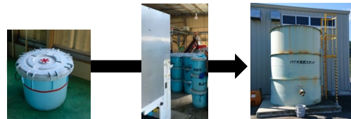
写真：生ゴミ (左) を破碎 (中央) し、メタン発酵処理を経てバイオ液肥 (右) が完成する。 (2020年10月27日撮影)
