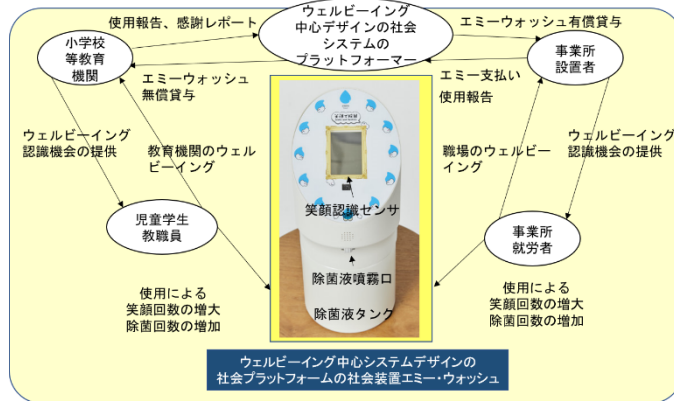
図2 エミー・ウォッシュのシステム概要図
