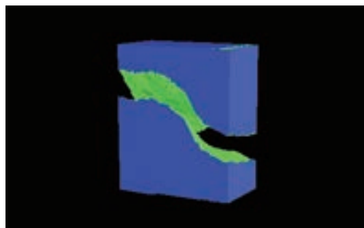
図2:あらかじめ斜めにき裂の入った直方体において、上下に引っ張ることで旋回しながら進むき裂
